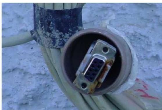
Figura VIII.11 – Danos nos sistema de leitura por infiltração de água.
