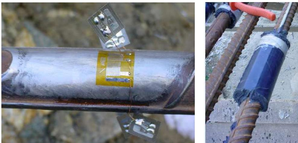
Figura VI.15 – Instalação e proteção dos pontos instrumentados.
